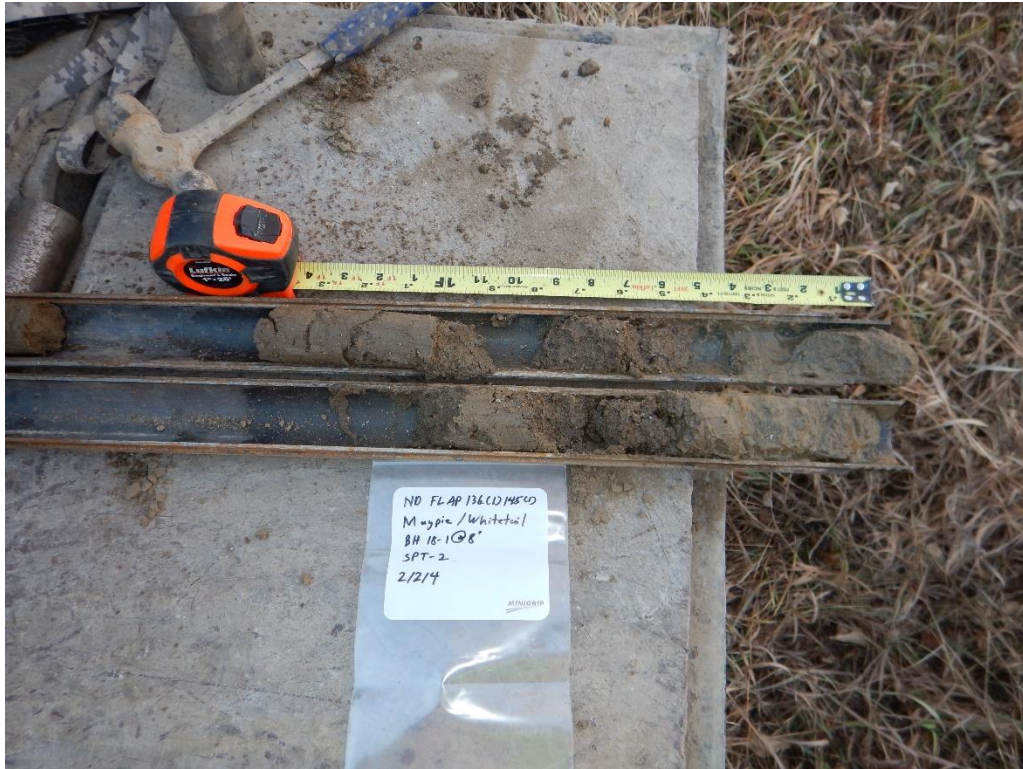
Photo 3:- Borehole BH18-01, SPT-2.
